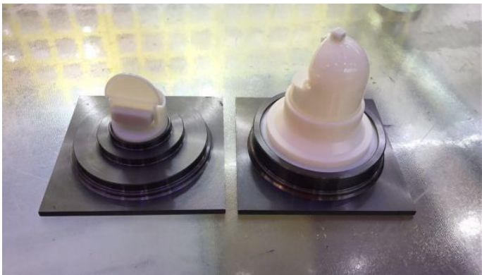
两种磁吸型重力翻板，从设计上看，右边的封闭效果更好
