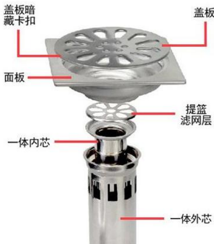
内外两层芯之间能存一些水，形成水封，实现防臭防虫。所以也叫水封式地漏，有浅水封和深水封之分，深水封相对存水多不易干，更好用一些。
