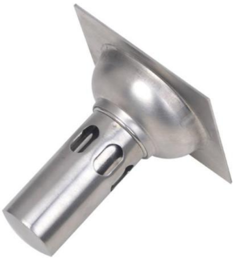
内外两层芯之间能存一些水，形成水封，实现防臭防虫。所以也叫水封式地漏，有浅水封和深水封之分，深水封相对存水多不易干，更好用一些。
